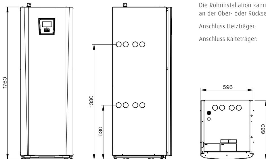
Die Rohrinstallation kann an der rechten oder linken Seite sowie an der Ober- oder Rückseite der Wärmepumpe erfolgen.
